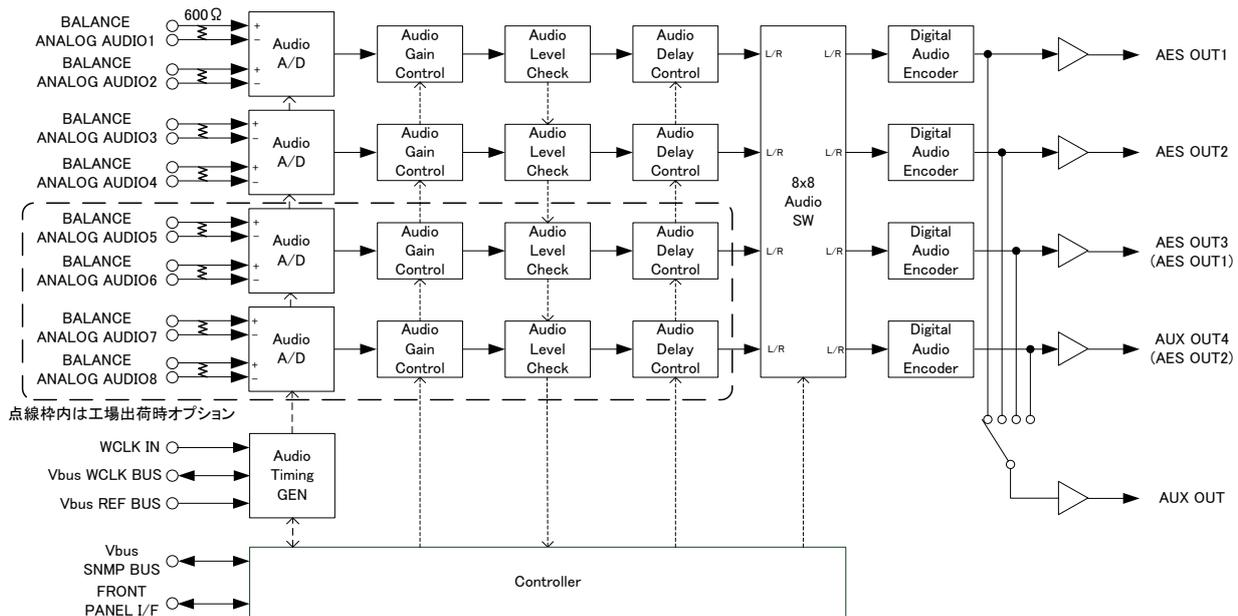
※オプションAES-70B-AES-01非搭載時は、AES OUT3はAES IN1のバッファー出力、AES OUT4はAES IN2のバッファー出力となります。
