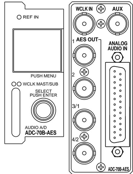
※1 リファレンス信号が無い場合インターナルクロックで48kHzのAES信号に変換します。 ※2 8音声出力は工場出荷時オプションADC-70B-AES-01が必要です。標準版は4音声出力です。 ※3 WCLK、DARS信号の分配機能は、Vbus筐体標準の映像のリファレンス分配機能とは別のバスを使用しており、一部の機種を除き、他モジュールとの併用が可能です。混在不可のモジュールは、TLG-70V、およびバス間通信機能を有効にしたTLG-70U、VT-70U、MMG-70Uです。
