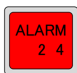
図 3.2.3 アラームスタンプ機能 (SDI IN2、SDI IN4のアラームスタンプ)
