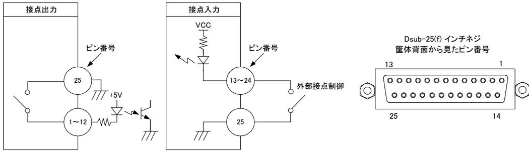
※ 接点出力の絶対最大定格は 28V、100mA です。外部抵抗で電流を 100mA 以下に制限してください。
