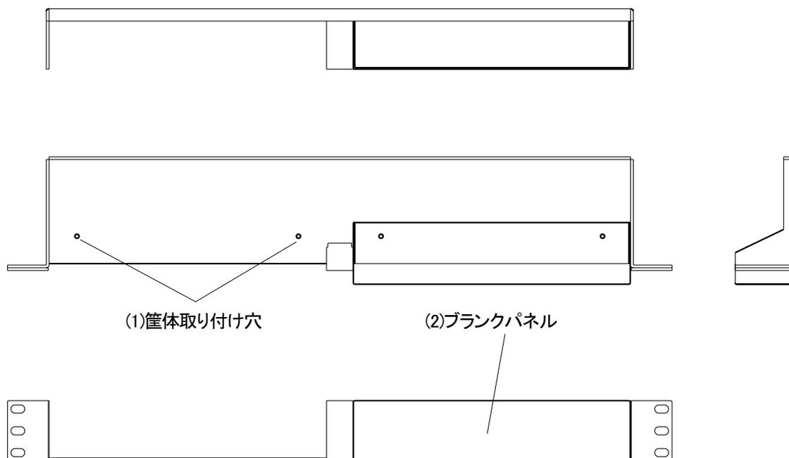
(1) 筐体取り付け穴・・・実装筐体を固定する時に使用する取り付け穴です。
