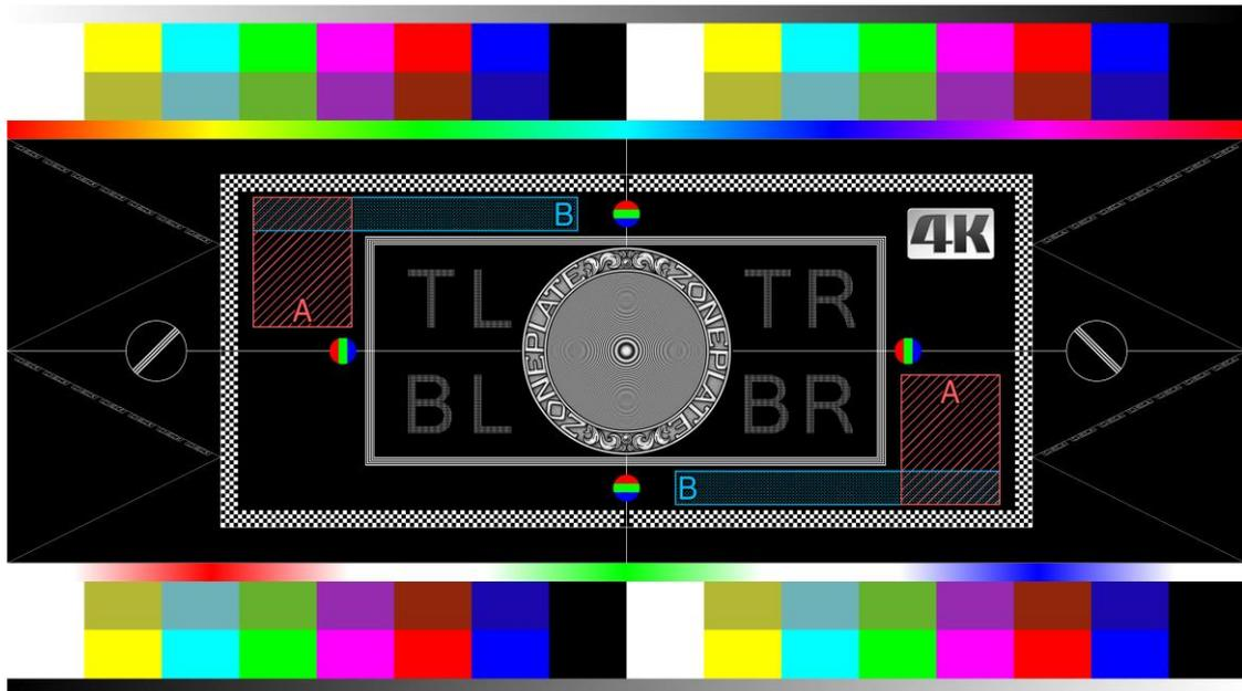
テストパターンへの埋め込み領域です。図の A の領域に縦長の素材を、B の領域に横長の素材を埋め込むことができます(SG-70V-01 付属パターンの右下のビデオトロンロゴは削除されます)。
