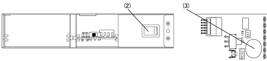
図6-2 前面パネル取り外し後
