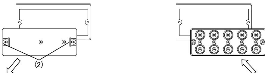
図 4-2 コネクターモジュールの取り付け
