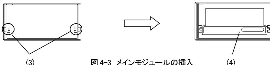
図 4-3 メインモジュールの挿入
