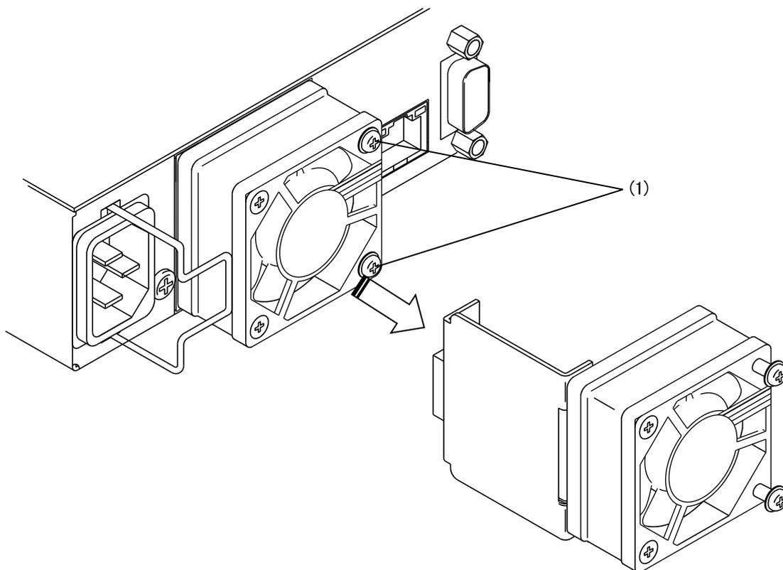
(1) M2.6 用ドライバにてファンユニット取り付けネジを空回りするまで緩めます。
