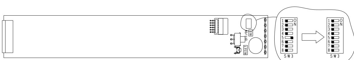
(3) 「6. SNMP ボード」の「6. Vbus-71C 工場出荷時設定への戻し方(P.11)」(5)、(8)、(9)の手順に従って元の状態に戻します。
