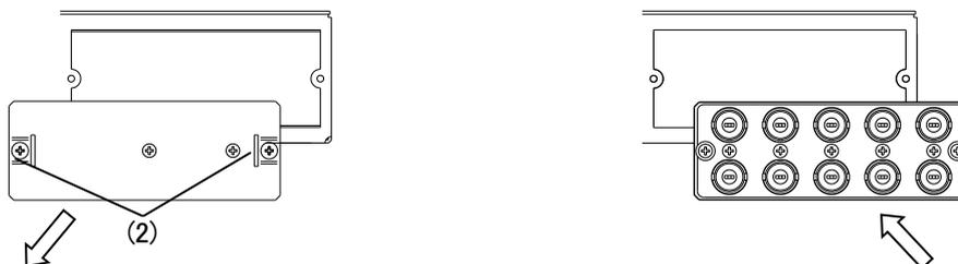
図 4-2 コネクタモジュールの取り付け
