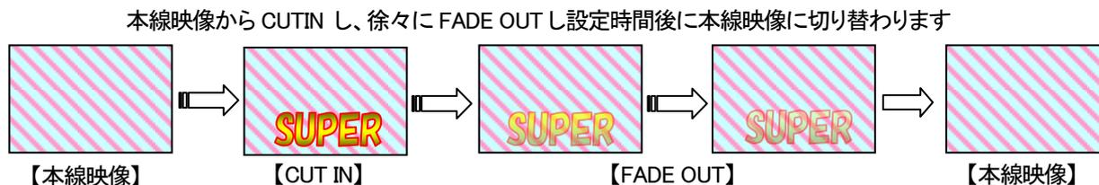
※1. メニュー画面の SYSTEM →REMOTE → FADE SPD → NONE が選択されているときは、メニューの FO SPEED で選択されている設定で FADE OUT します。メニュー画面の SYSTEM →REMOTE → FADE SPD → VARID が選択されているときは、GPI の PIN3、PIN4 で選択された FADE SPEED で FADE OUT します。GPI を使用する際は、CUT 以外の SLOW、MID、FAST を選択してください。
