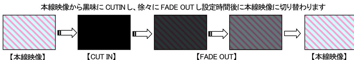
※1. メニュー画面の SYSTEM → REMOTE → FADE SPD → NONE が選択されているときは、メニューの FO SPEED で選択されている設定で FADE OUT します。メニュー画面の SYSTEM → REMOTE → FADE SPD → VARID が選択されているときは、GPI の PIN3、PIN4 で選択された FADE SPEED で FADE OUT します。GPI を使用する際は、CUT 以外の SLOW、MID、FAST を選択してください。
