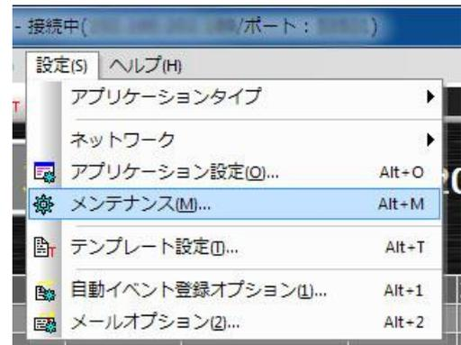
2)メンテナンスダイアログが表示されたら、必要に応じて本体ログの取得及び本体プログラムのバージョンアップを行います。
