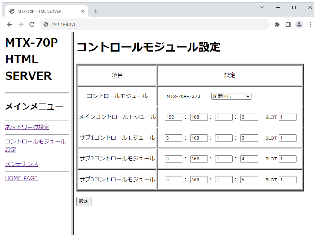
図4.13 コントロールモジュール設定
