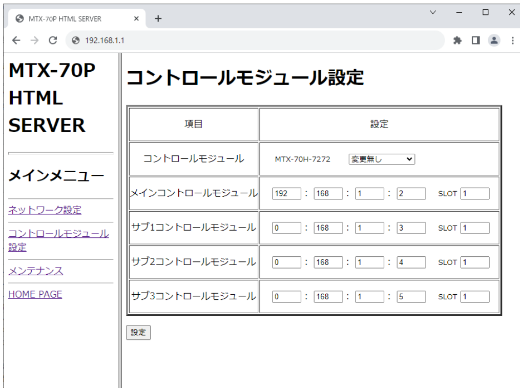
図4.13 コントロールモジュール設定
