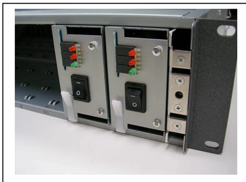
交換用電源ユニットを挿入します。
