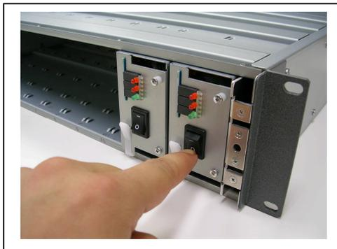
交換を行う電源ユニットの電源スイッチを
