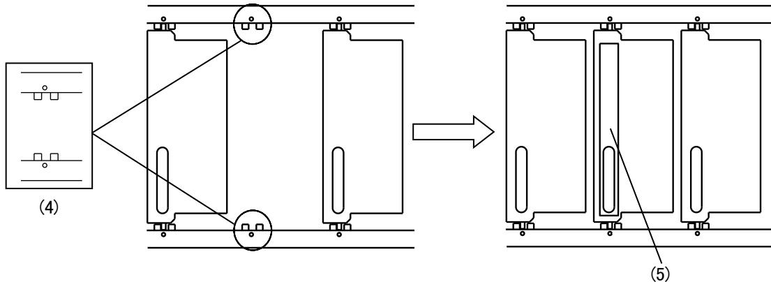
図 4-3 メインモジュールの挿入
