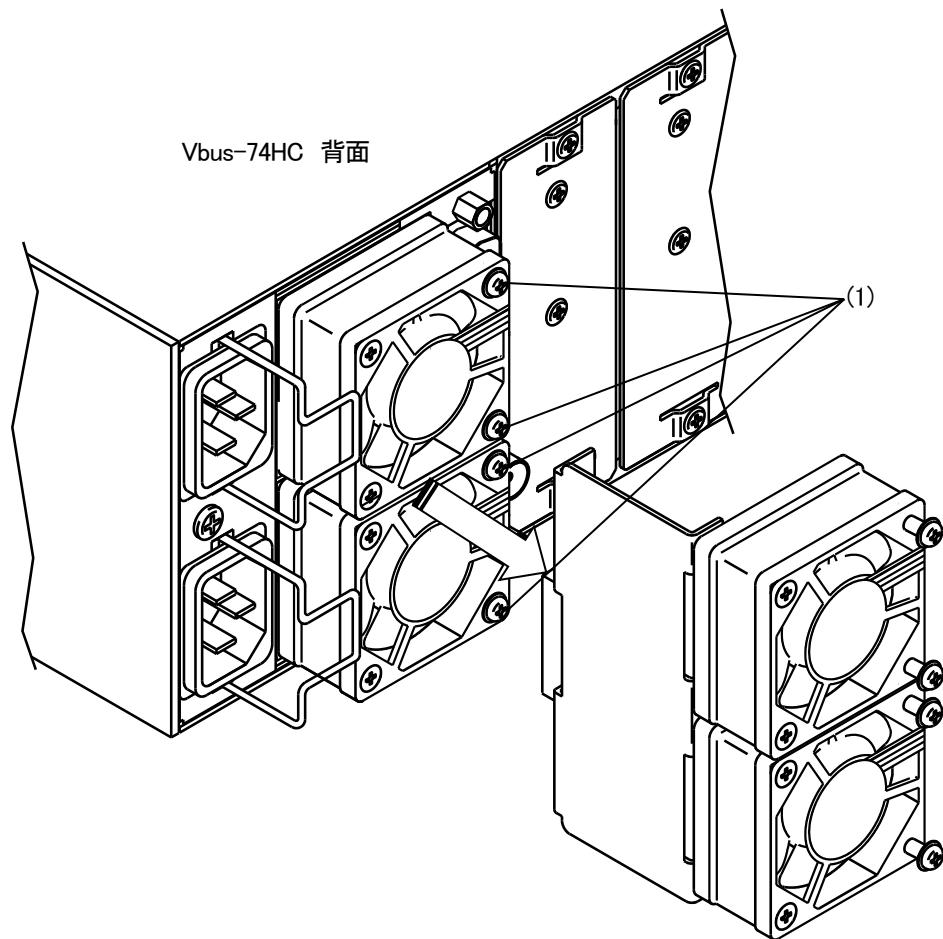
(1) M2.6 用ドライバにてファンユニット取り付けネジを空回りするまで緩めます。
