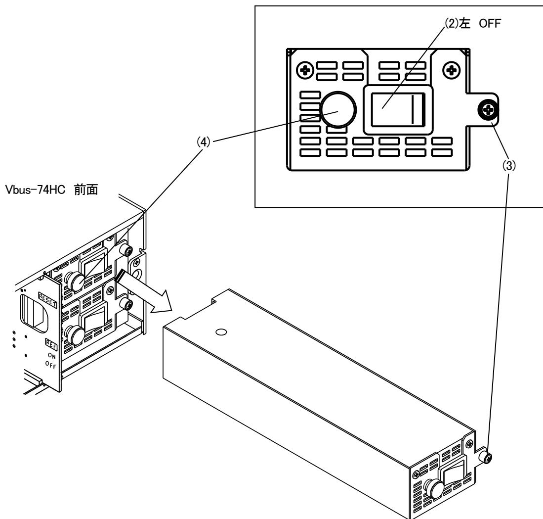
(1) 前面パネル固定用ネジ 図 5-1 (1-1) を十分に緩め、左側の取手
