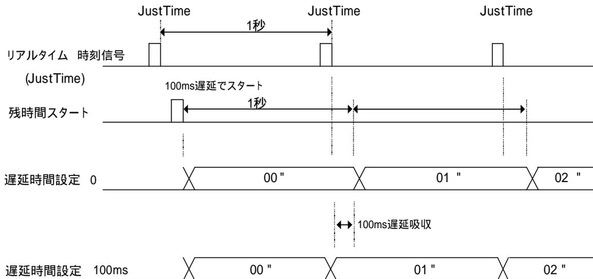
時刻の遅延時間設定も同上の動きになり、時刻カウントを早める方向に作用します。
