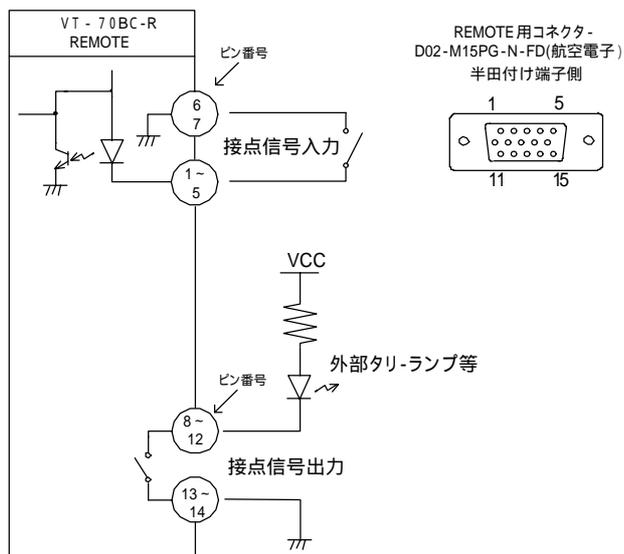
\*\*1 接点信号入力をロジックで制御する場合、吸い込み電流が12mAまで耐えられるデバイスで駆動してください。
